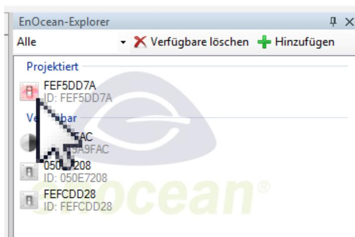
2. Bei Lichtschaltern wird bei Empfang einer Nachricht angezeigt, welches der vier Schaltelemente betätigt wurde, solange der Taster/Schalter betätigt wird. Wählen Sie hierzu im EnOcean-Explorer mit einem einfachen Mausklick den Schalter an, den Sie untersuchen wollen. Wenn Sie nun eine Taste drücken und halten, sehen Sie im Eigenschaftsfenster im EnOcean-Explorer unter Wert den aktuell gedrückten Taster (A0/A1/B0/B1).
