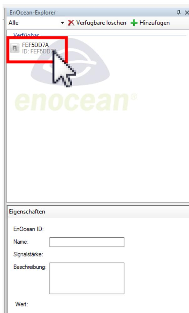
2. Durch einen doppelten Mausklick links wird der Lichtschalter "projektiert". D.h. diesem Schalter können anschließend Funktionen zugewiesen werden und er gehört zum Projekt. Schalter, welche nicht durch einen Doppelklick projektiert werden, können durch Anwahl des Buttons "Verfügbare löschen" jederzeit aus der Ansicht gelöscht werden.
