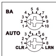
**Der untere Drehschalter** wird für das Einlernen von verschlüsselten Sensoren benötigt und wird im Betrieb auf AUTO 1 gestellt.
