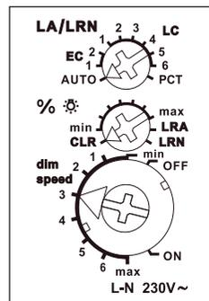
**Der obere Dreheschalter LA/LRN** wird zunächst zum Einlernen benötigt und legt im Betrieb fest, ob die automatische Lampenerkennung wirken soll, oder spezielle Comfort-Stellungen:
