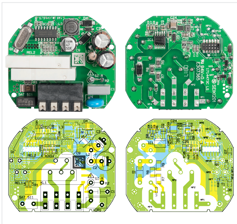
Bild 6: Platinenfotos der vollständig bestückten Leistungseinheit mit zugehörigen Bestückungsplänen, links die Oberseite, rechts die Unterseite
