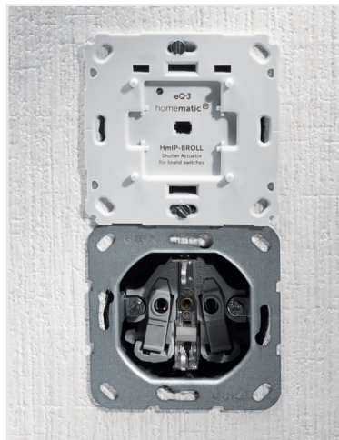
Bild 17: ... wird in die Installationsdose eingesetzt und verschraubt.
